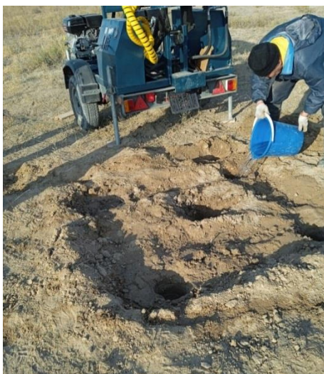
Рисунок 4. Повторное заполнение опытных скважин водой.
