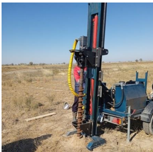
Рисунок 1. Контрольное бурение для определения естественной влажности почвы и наличия грунтовых вод.
